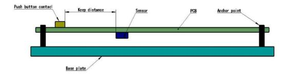
c) 气压计远离热源器件(包括 PCB 双面);
