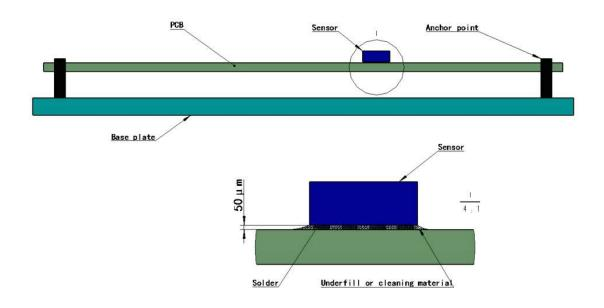
g) PCB layout 设计建议如下图。layout 开窗较大会增加锡量,从而增加锡膏 挥发的风险 (其中若贴片精度较差可适当增加开窗尺寸)。
